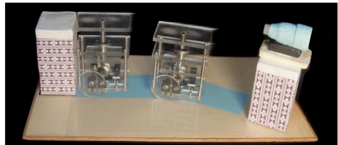
バネの復元力で、台車は元の位置に戻る
